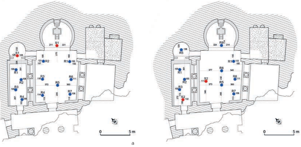
SOLDA Merkez ve kuzey nefte S1 (a) ve S2 (b) kaynak konumlarına göre ölçüm noktalarının dağılımı ve ilgili mesafeler (ölçüler cm'dir). Plan şeması Lemaigre Demesnil'den (2010) alınmış, ölçüm noktaları ve mesafeler yazarlar tarafından işlenmiştir (Görsel 6).
