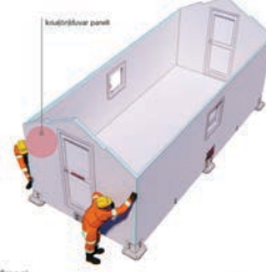
08 Kısa (ön) duvar panelinin O2 yerleştirilmesi
