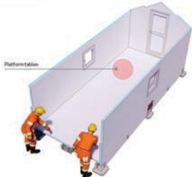
07 Platform tablasının yerleştirilmesi
