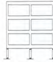
Kirişleri kolonlarından daha yüksek dayanımlı yapı
