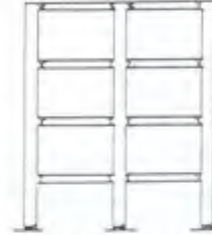
Kolonları kirişlerden daha yüksek dayanımlı yapı
