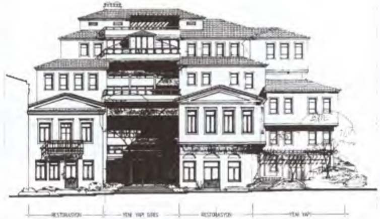
Kuzeybatı görünüşü, restorasyon
