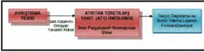
Şekil 5. Atıktan Türetilmiş Yakıt Ünitesi İş Akım Şeması
